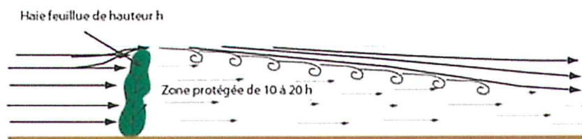
Figure 2 : Effet d'une haie sur la dispersion des odeurs
